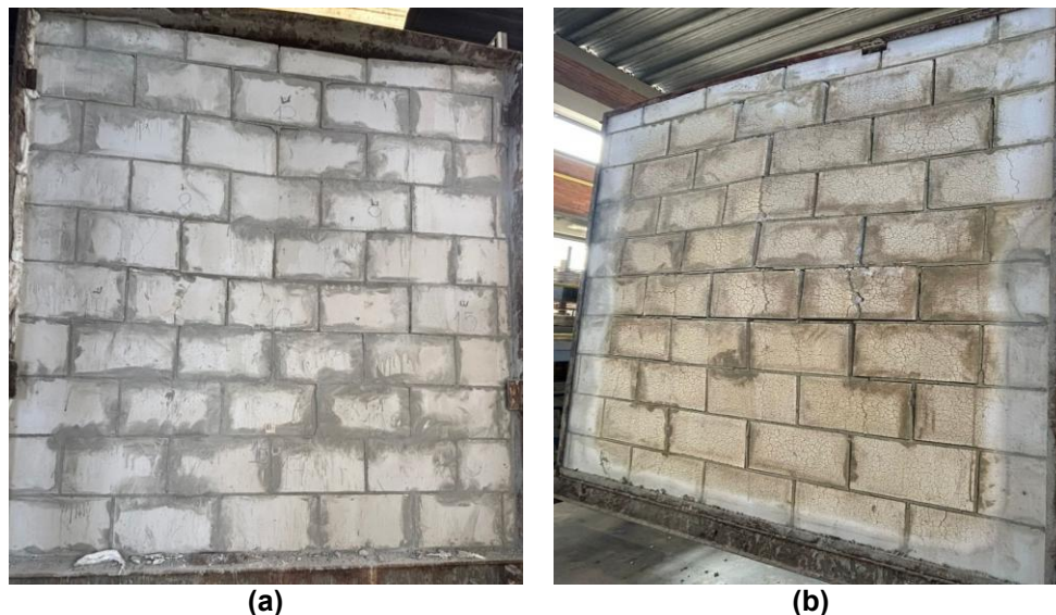
Figura 8 – Aspecto da amostra após o ensaio: (a) face não exposta às elevadas temperaturas e (b) face exposta às elevadas temperaturas
